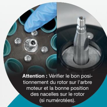
**Attention :** Vérifier le bon positionnement du rotor sur l'arbre moteur et la bonne position des nacelles sur le rotor (si numérotées).
